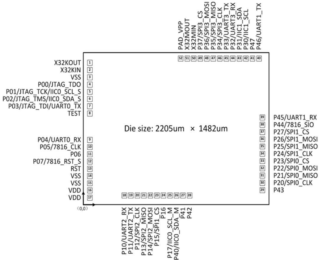
图 8-1 Die (裸片) 引脚示意图
